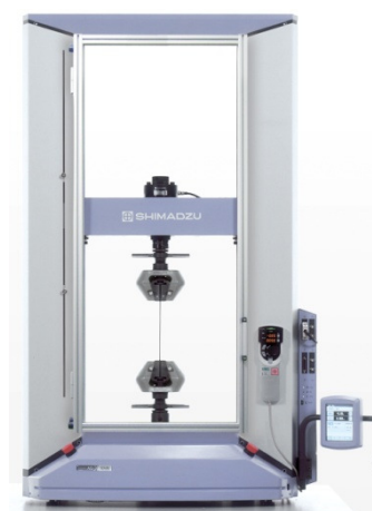
Figura 1. Máquina de ensaios universal servo-elétrica, modelo AG-X, capacidade 10kN.
